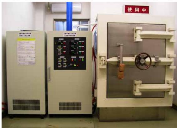
写真1. 低酸素濃度処理装置
