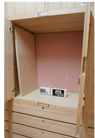
図 9 吸着ボード（ピンク色）設置棚
