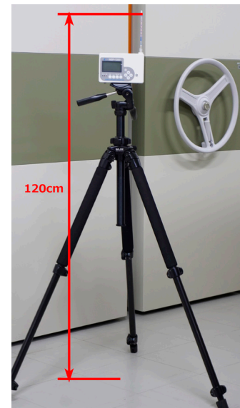
図 3 アンモニアおよびホルムアルデヒドの測定
