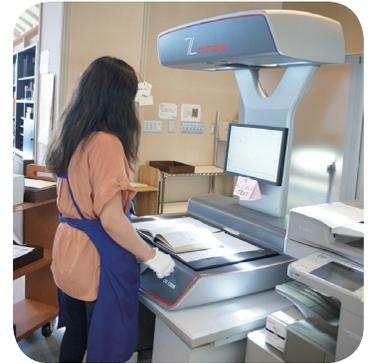
オーバーヘッドスキャナーを用いて資料を押しさえつけずにコピーをします。
