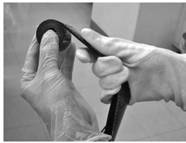
図 4 触診による劣化調査
